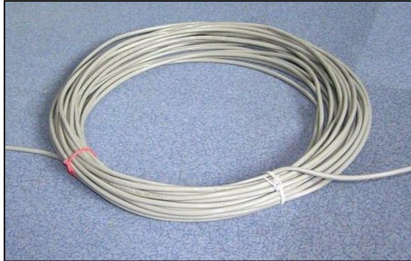
**Gambar 3.5** Kabel CAT 5e Kantor Dinas P.U Bina Marga
