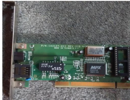
Gambar 3.6 Network Interface Card (NIC) yang digunakan pada PT Pos Indonesia (Persero) Cabang Merdeka Palembang
