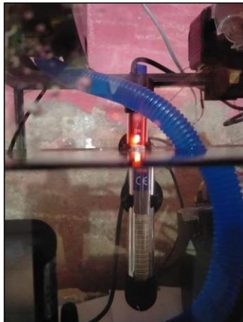
**Gambar 5.35 *Water Heater* Hidup Pada Suhu Rendah**
