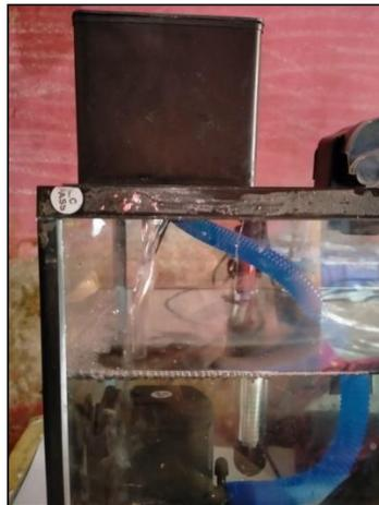
**Gambar 5.37 *Filter* Mati Pada Kekeruhan Tinggi**
