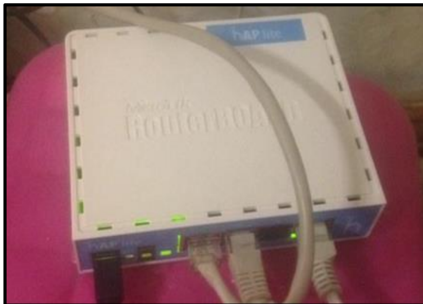
Gambar : 3.3. Mikrotik RB941-2nD.
