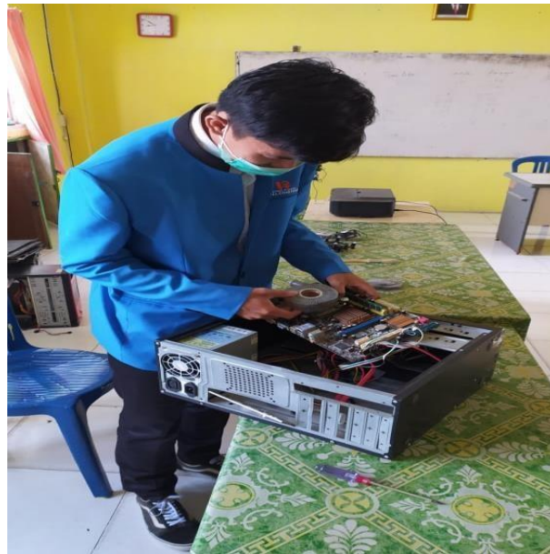
Gambar 3.3 Melakukan Perakitan Komputer
