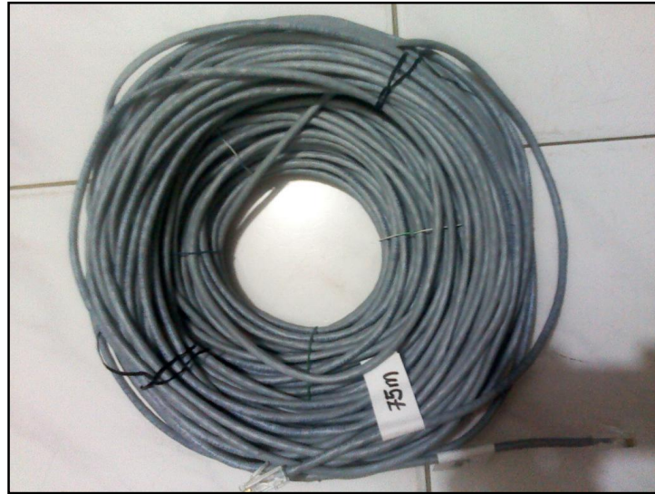
Gambar 3.5 Kabel UTP CAT5e
