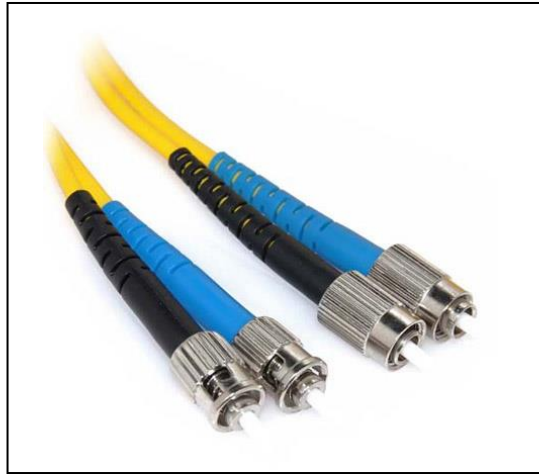
Gambar 2.7 Kabel Fiber Optic Beserta Konektornya
